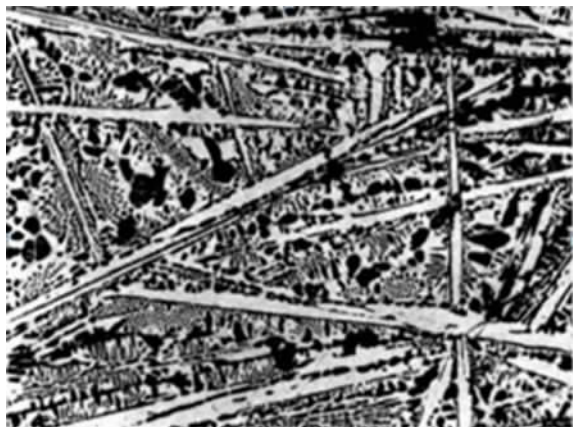
图4 山西天马-曲村残铁片金相组织,白口铁组织( \times 100 )
